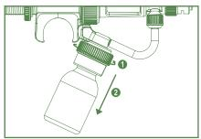
Spritze auf den Kopf drehen. Verschluss abschrauben um Flasche zu entfernen.
