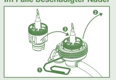
Klammer gedrückt halten und Nadeleinheit herausziehen. Neue Nadeleinheit einsetzen.
