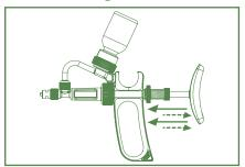
Spritze umdrehen, durch Betätigung des Kolbens Flüssigkeit ansaugen.
