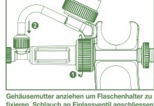
fixieren. Schlauch an Einlassventil anschliessen.
