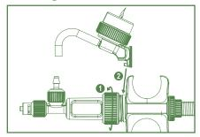
Gehäusemutter abschrauben. Befestigung des Flaschenhalters bis zum Anschlag einführen.
