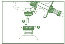
Spritze auf den Kopf drehen, mit Nadel Flaschenpfropfen durchstechen. Verschluss zuschrauben um Flasche zu verschliessen.
